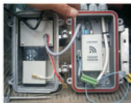
Внутреннее расположение прибора с аккумуляторной батареей
